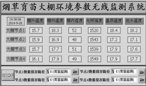
图8 上位机无线监测中心数据显示结果
