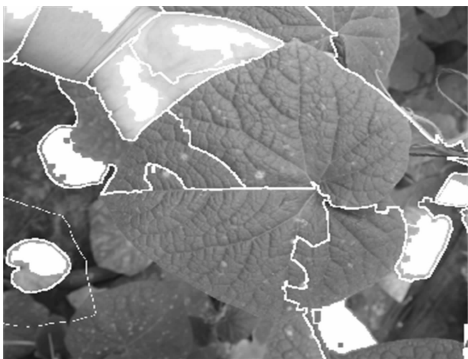
图4 基于标记的分水岭算法分割结果
