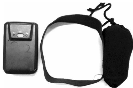
图2 定位项圈示例
