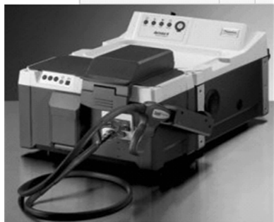
图1 近红外光谱采集设备系统
