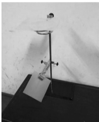
图4 碰撞恢复系数测试装置
