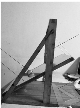
1—测量装置；2—三角板；3—马铃薯；4—镀锌钢板 图3 静摩擦系数测定装置
