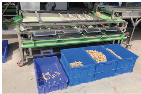
图7 发散带式花生荚果分级机试验效果
