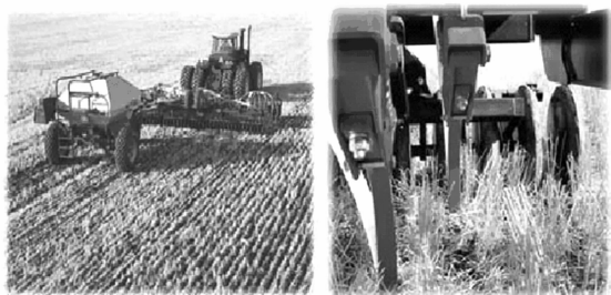
图3 Flexi-coil 5000 型免耕播种机
