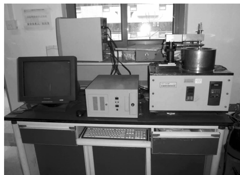
图 1 HT-500 高温摩擦磨损试验机
