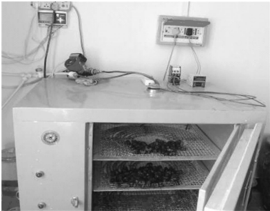
图2 太阳能加热烘干试验装置
