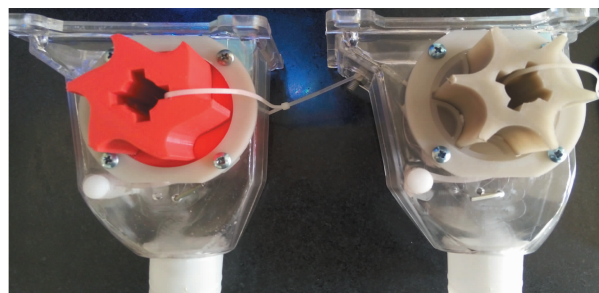
图6 外槽轮排肥器
