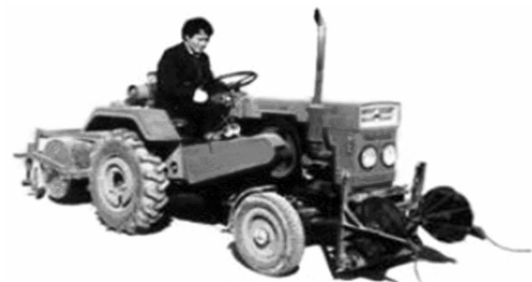
图11 玉米整秆半覆盖机
