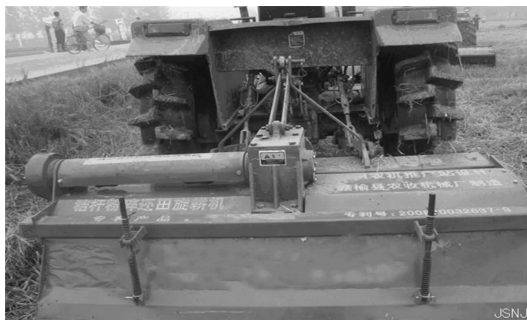
图7 1JHG-180 型秸秆粉碎还田旋耕机
