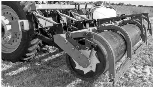
图10 秸秆压倒田间覆盖机
