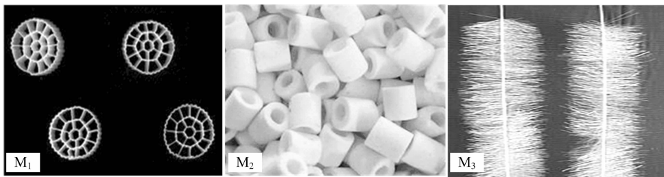
M 1 —聚乙烯小球填料；M 2 —陶瓷环填料；M 3 —弹性毛刷填料
