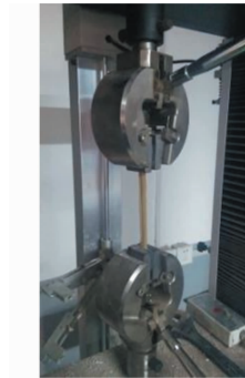
图4 秸秆抗拉性能测试
