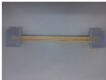
图3 制备好的抗拉试验的秸秆试样
