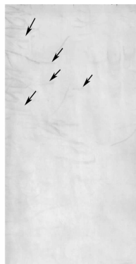
图6 玻璃棒赶气泡对尼龙膜的损伤
