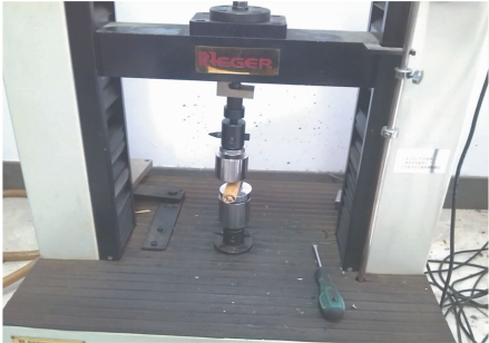
图3 压缩试验夹持方法
