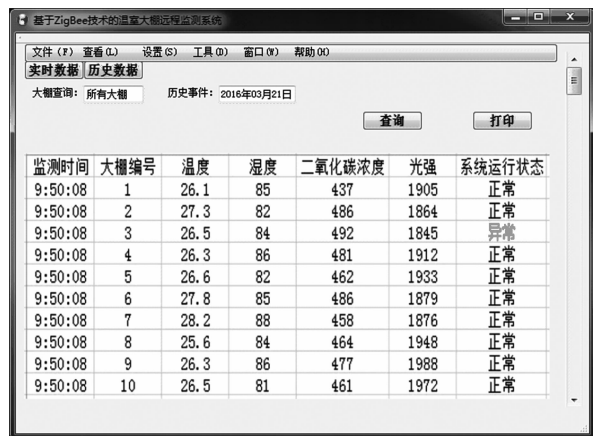
图9 远程监测中心上位机显示界面
