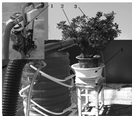
1—静电喷雾机;2—静电喷头;3—冠层;4—集雾盆;5—电子秤
