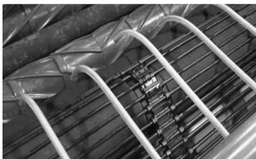
图4 杆辊夹持式分离装置
