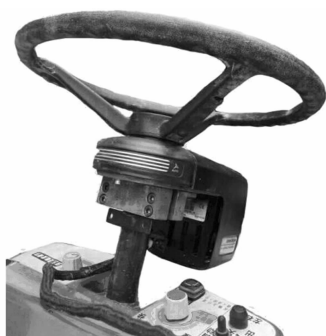
图3 自动导航方向盘在插秧机上的安装情况
