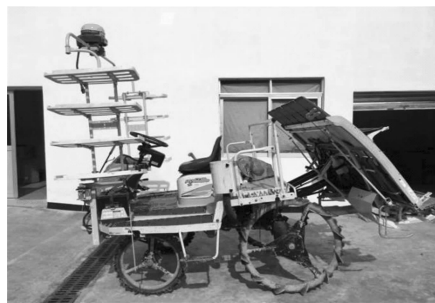
图4 自动导航插秧机
