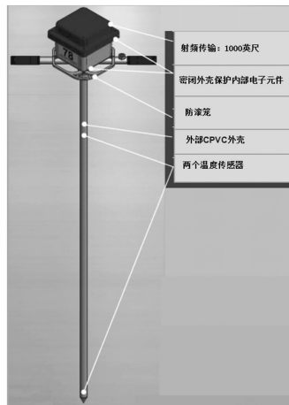
图2 REOTEMP 公司生产的无线温度探杆结构示意图
