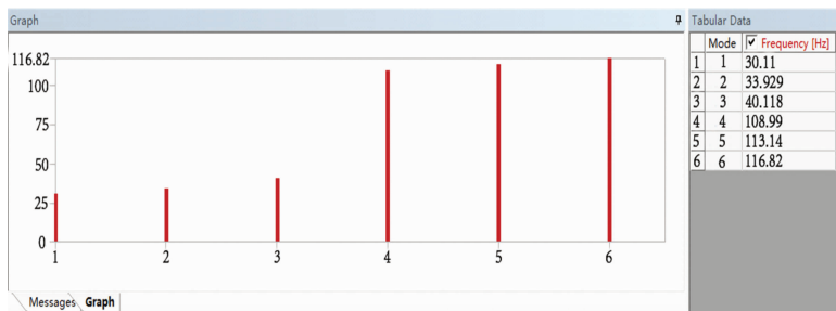
图4 机架前6阶固有频率
