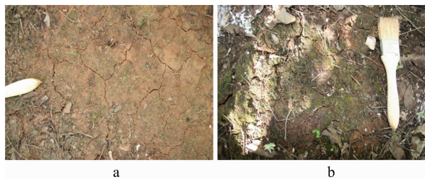
图5 试验区发育的土体干裂缝
