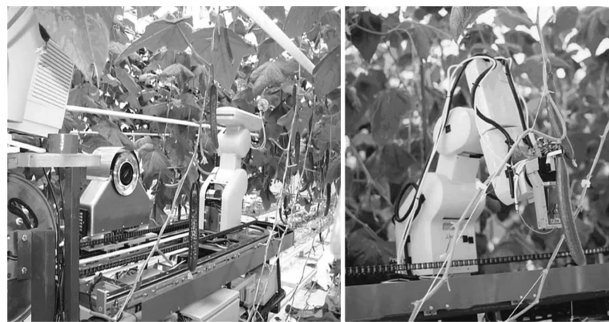
图3 荷兰农业环境工程研究所研制黄瓜收获机器人采摘试验
