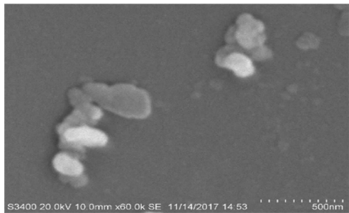
图1 纳米氧化铜扫描电镜结果
