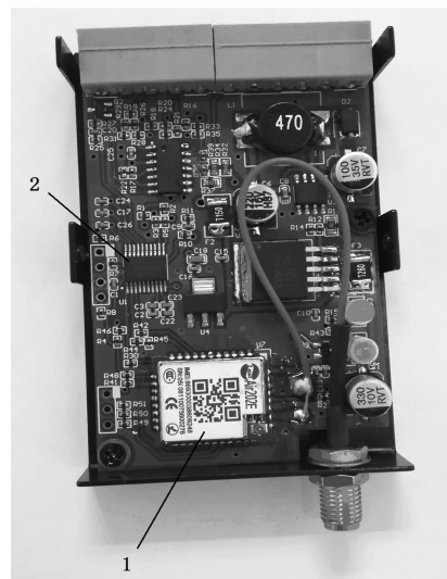
1—GPRS 通信模块; 2—微控制器
