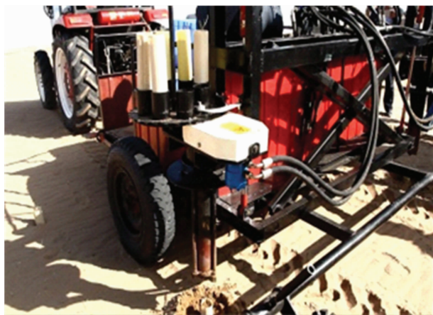
图1 竹柳移栽种植机械
