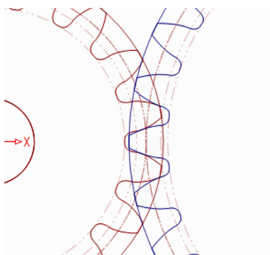
图4 大节距渐开线( 20^{\circ} ) 齿轮
