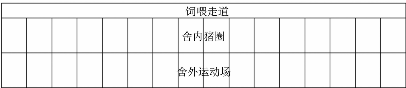
图1 福利化半舍饲猪舍平面布局示意图
