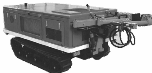
图1 履带式偏心核桃振动采收机 [17]
