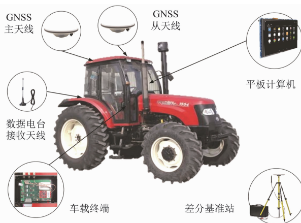
图5 东风 DF1004-2 试验平台 [89]
